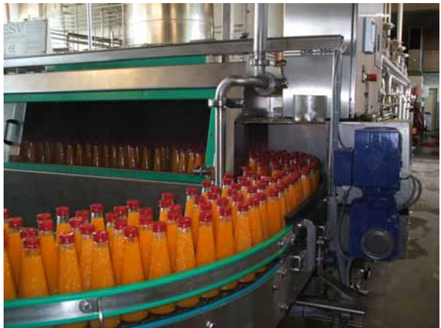
Lowara-Pumpen sichern den Produktionsprozess beim Pasteurisieren der Säfte
